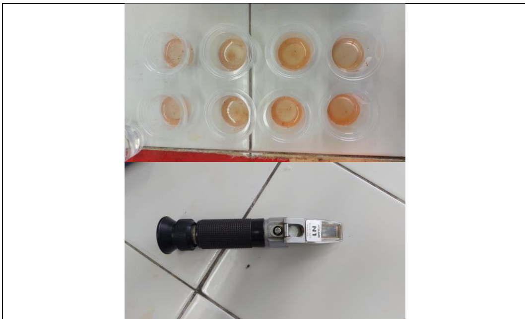
Gambar 36. Dokumentasi Pengujian Total Padatan Terlarut Menggunakan Hand Refractometer
