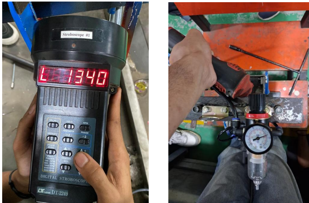
Gambar 34. Hasil pengujian menunjukkan putaran 1340 rpm dan tekanan 65 psi
