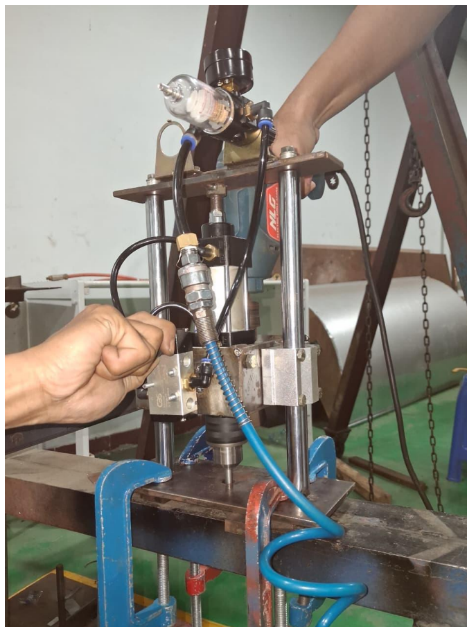
Gambar 33. Alat friction welding portable yang telah selesai dirakit
