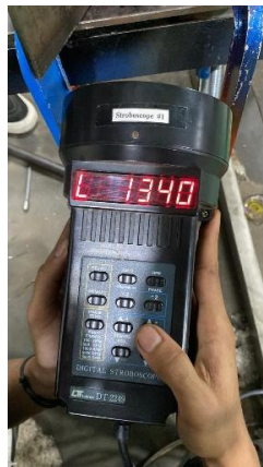
Gambar 21. Pengukuran putaran spindle tanpa beban menggunakan stroboscope
