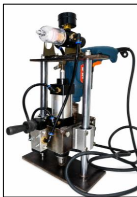
Gambar 15. Alat friction welding portable yang digunakan pada proses pengujian
