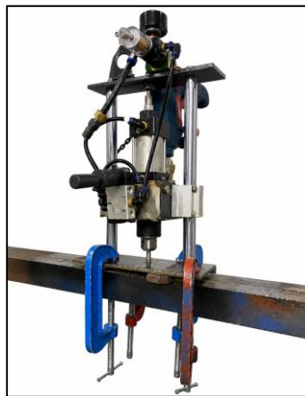
Gambar 14. Pengujian menggunakan alat friction welding
