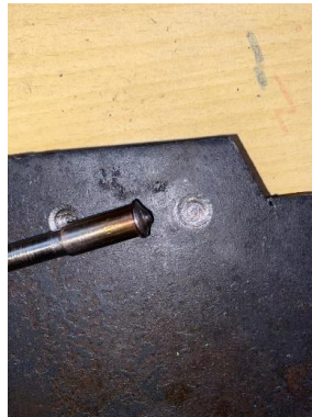
Gambar 19. Hasil pengujian menggunakan alat friction welding portable
