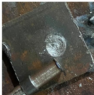
Gambar 17. Hasil pengujian menggunakan alat friction welding portable
