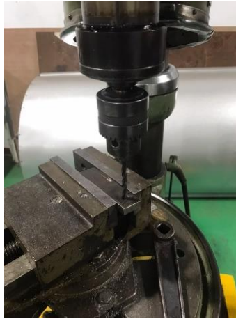
Gambar 14. Proses drilling pada pelat
