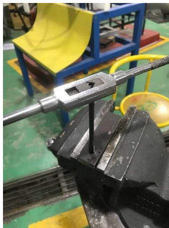
Gambar 15. Proses tapping pada pelat
