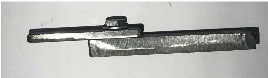
Gambar 22. Percobaan dengan menggunakan ring pelat ( flat washer )
