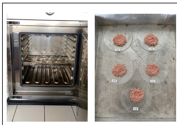
Gambar 22. Dokumentasi Analisis Kadar Air Metode Gravimetri
