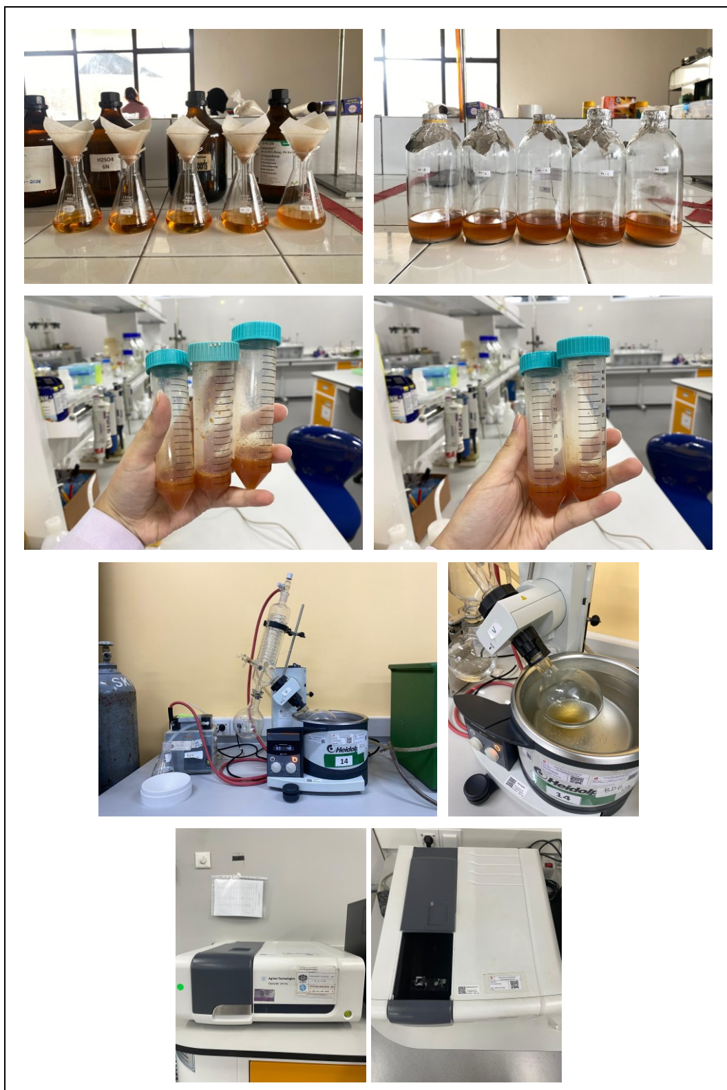
Gambar 28. Dokumentasi Analisis Kadar Antosianin Metode pH Differential
