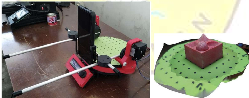
Gambar 4. Hasil rancang bangun mesin pemindai 3D
