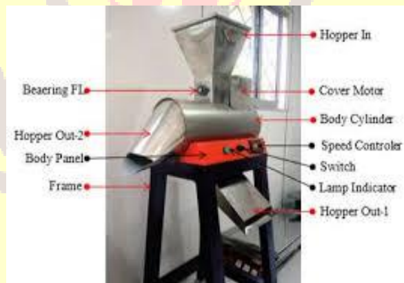
Gambar 5. Mesin pengupas kuaci skala industri [21].
