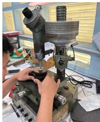
Gambar 20. Pengujian Hardness Vickers
