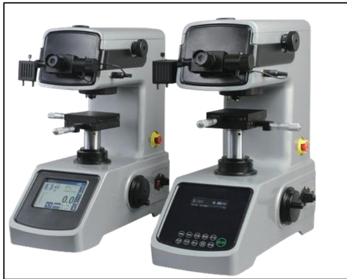
Gambar 9. Mesin Hardness Vickers [23].
