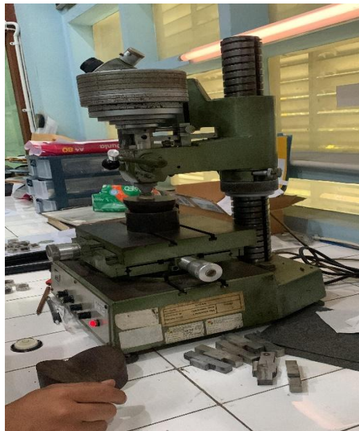
Gambar 20. Proses pengujian kekerasan vickers
