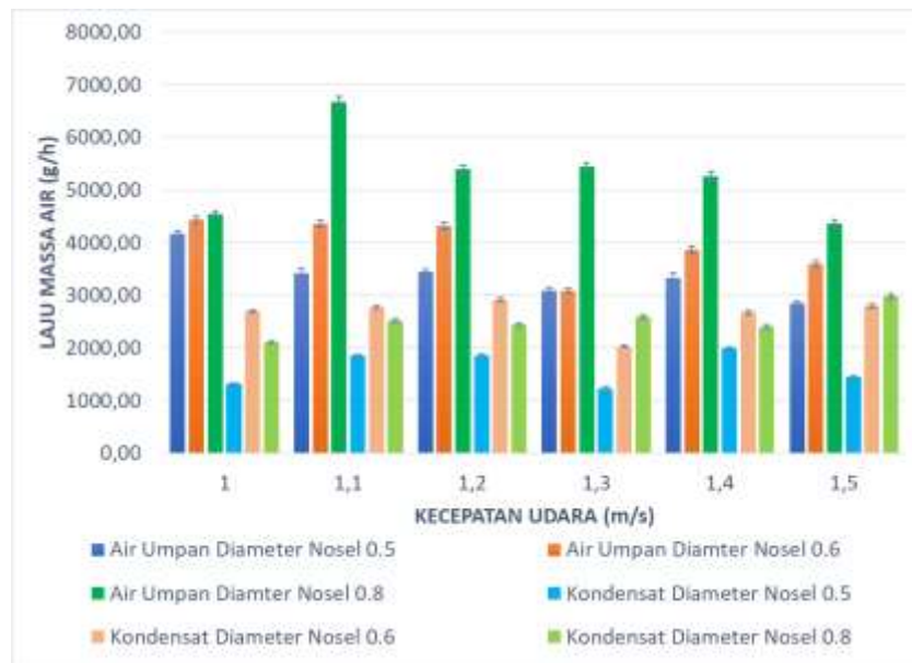
Gambar 18. Grafik produktivitas kondensat pada temperatur heater 130 °C
