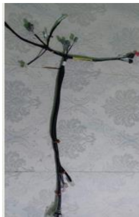
Gambar IV.2 Wiring Harness SE-085 PT. Chakra Tunggal Elektrindo
