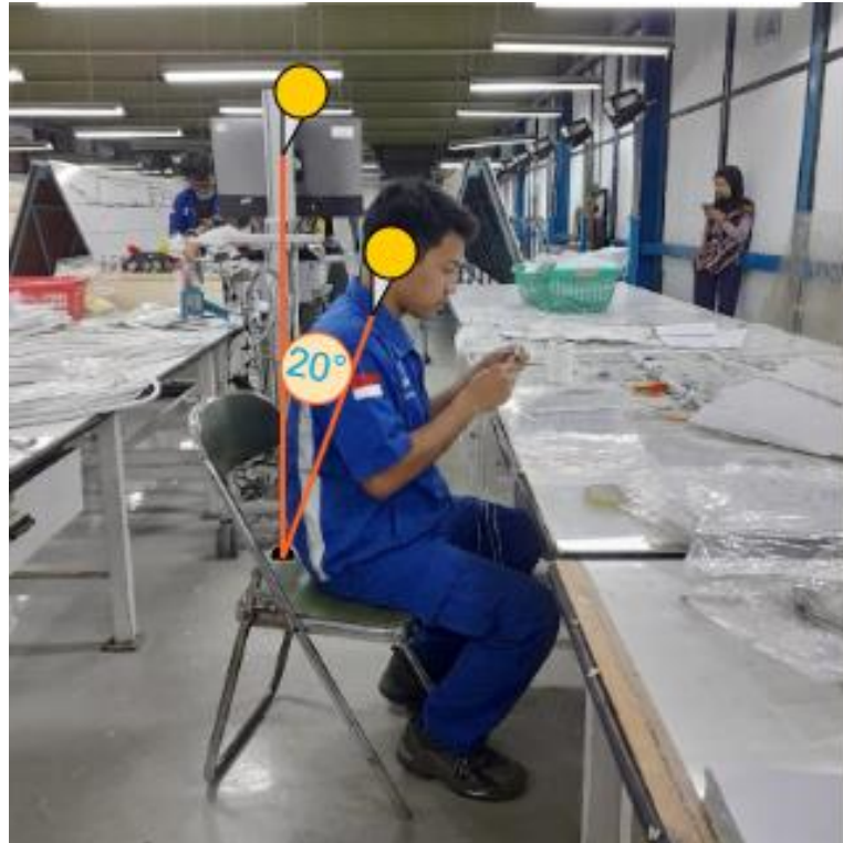
Gambar IV.44 Besaran Derajat Sudut Punggung Pekerja 10
