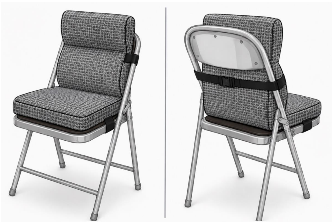
Gambar V.6 Ilustrasi Pemasangan Bantalan Duduk Ergonomis
