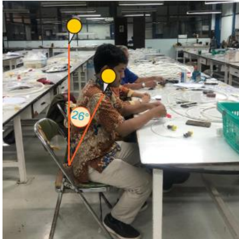
Gambar IV.41 Besaran Derajat Sudut Punggung Pekerja 9
