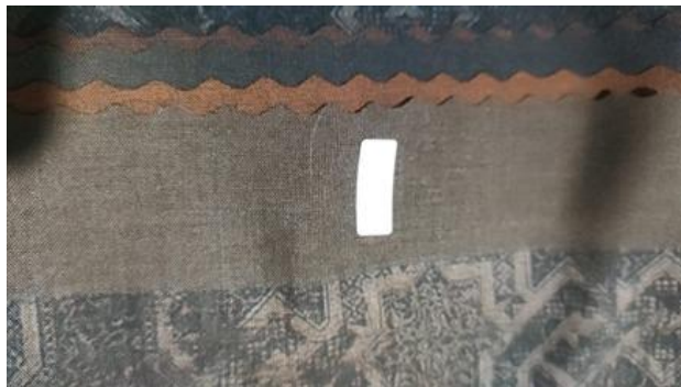
Gambar IV.4 Cacat Benang pada Produk Hijab
