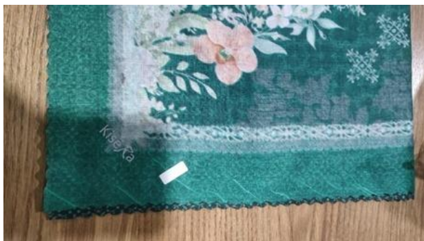
Gambar IV.5 Cacat Lipat pada Produk Hijab
