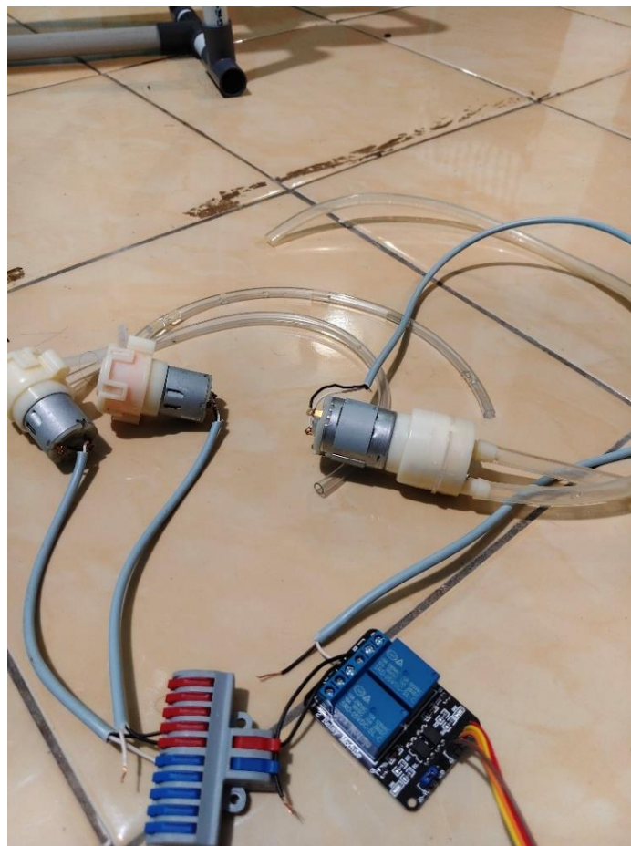
Gambar 4.15 Modul Relay dengan Pompa Air dan Nutrisi
