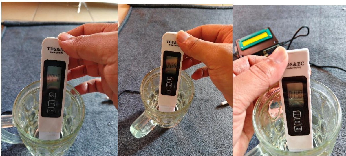
Gambar 4.23 Pengujian Pembanding TDS di Ketiga Larutan
