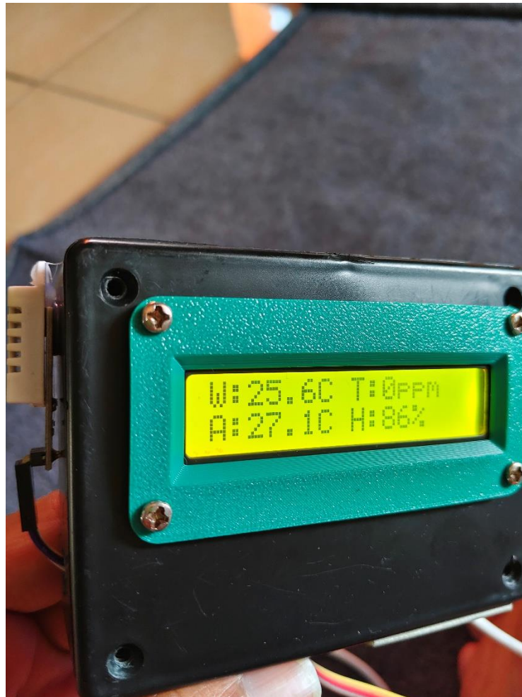
Gambar 4.21 Hasil Pembacaan Sensor DHT22
