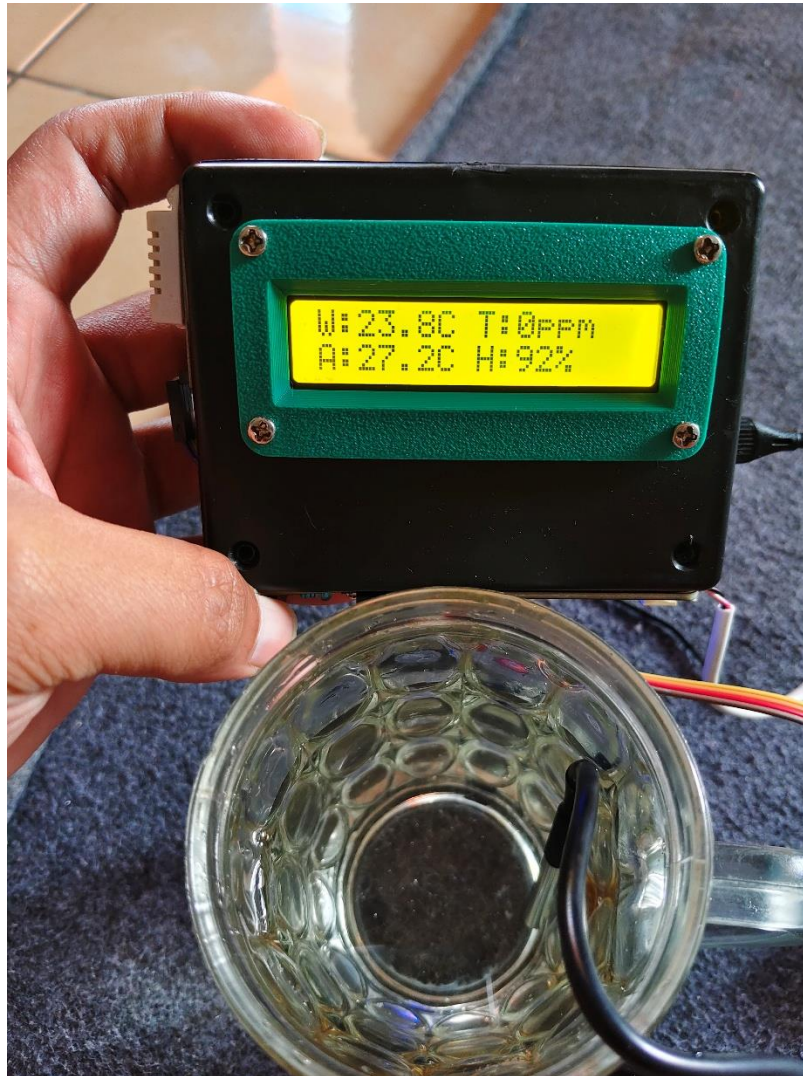
Gambar 4.24 Pengujian Sensor DS18B20
