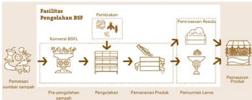
Gambar 3.8 Unit-Unit dalam Sistem Pengolahan BSF
