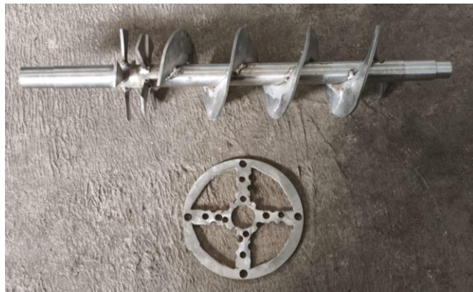
Gambar 4.8 Hasil Modifikasi Poros Pencacah
