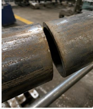
Gambar IV. 5 Defect Sudut Potong Tidak Presisi
