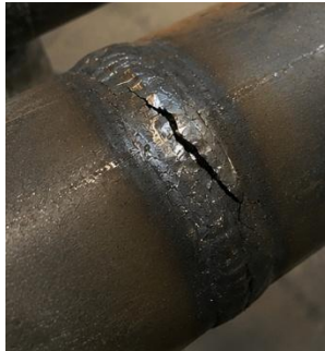
Gambar IV. 6 Defect Terdapat Retak ( Crack )
