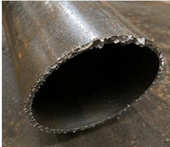
Defect Sambungan Las Tidak Rata
