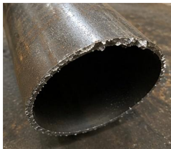
Gambar IV. 7 Defect Sambungan Las Tidak Rata
