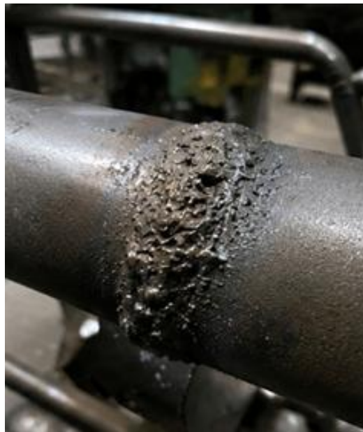
Defect Terdapat Porositas Berlebih (Porosity)
