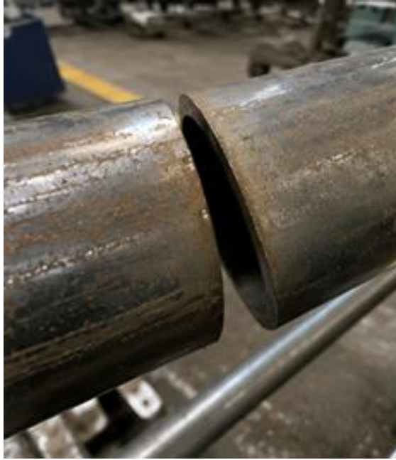
Defect Sudut Potong Tidak Presisi
