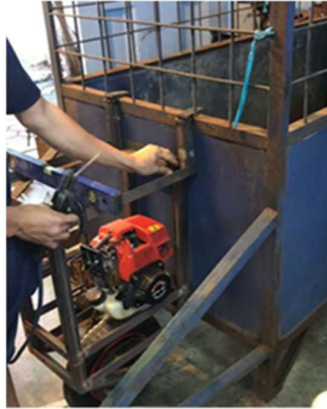
Gambar 19 Pemasangan pengait pada bagian depan gerobak
