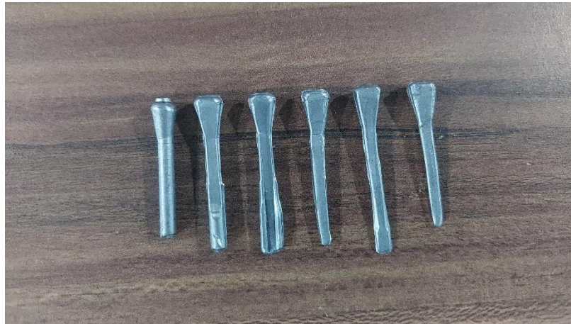
Gambar 43. Hasil penempaan dari tahap 1 hingga tahap 6
