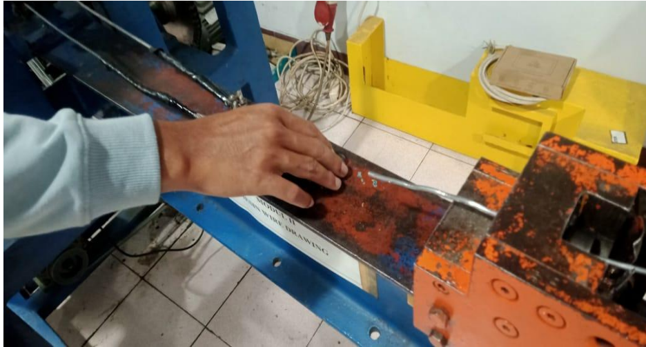
Gambar 29. Proses pengecilan benda kerja menggunakan wire drawing
