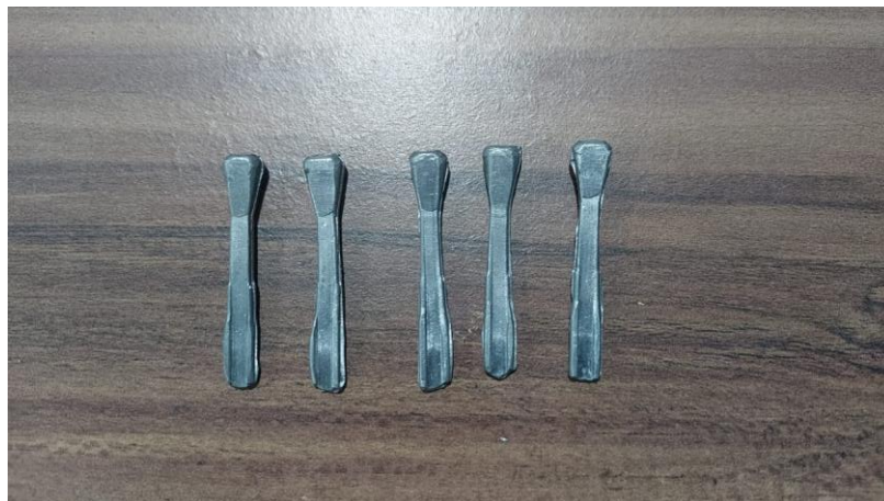
Gambar 44. Hasil penempaan proses pembentukan paku tapal kuda tahap 3
