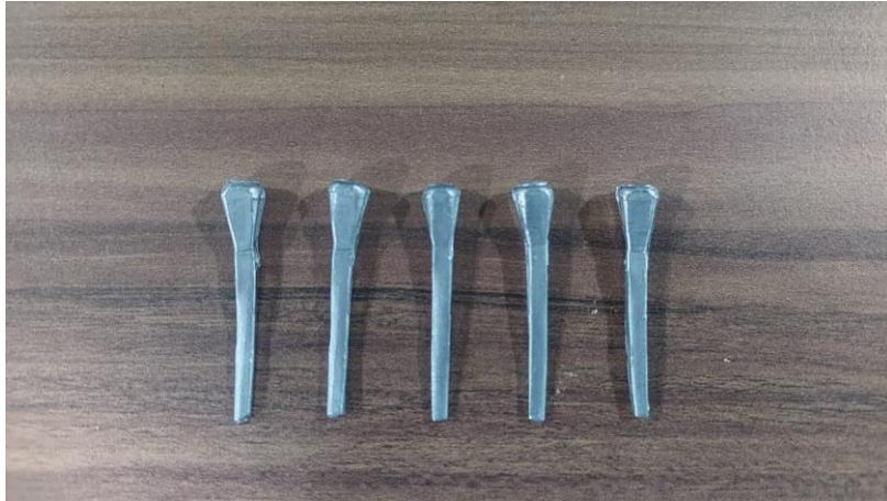
Gambar 45. Hasil penempaan pada proses pembentukan paku tapal kuda tahap 4
