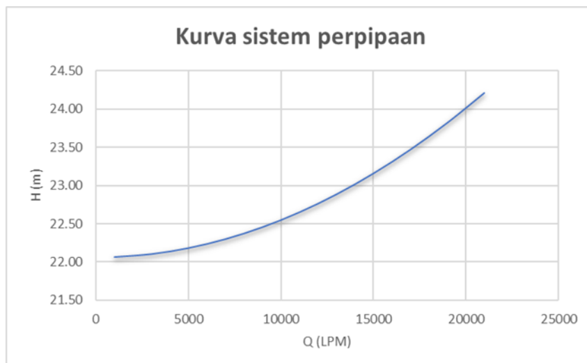
Gambar 42. Kurva sistem perpipaan alternatif kedua
