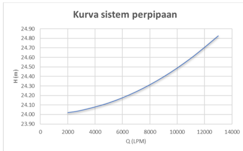
Gambar 36. Kurva sistem perpipaan alternatif pertama
