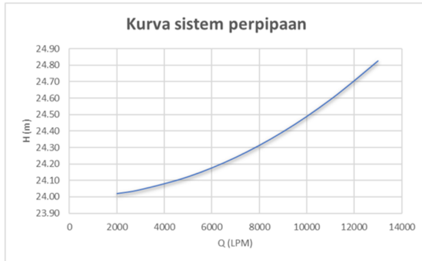
Gambar 36. Kurva sistem perpipaan alternatif pertama
