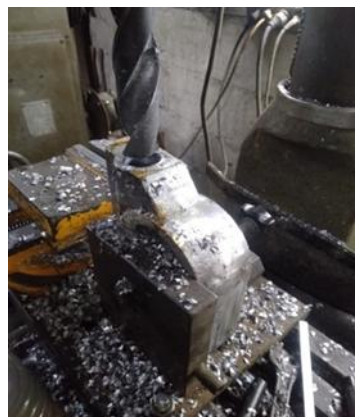
Gambar 18. Prosels drilling membuat lubang baut pada cover housing
