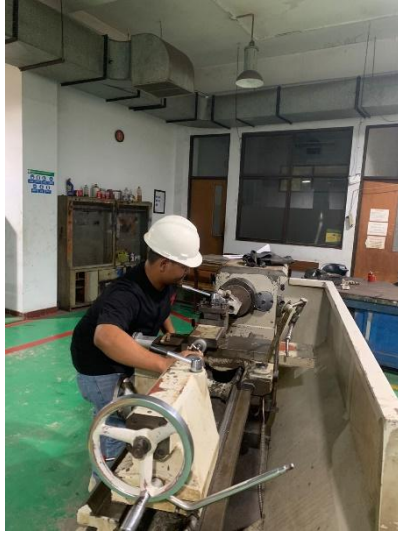
Gambar 24. proses membersihkan bagian dalam gear box
