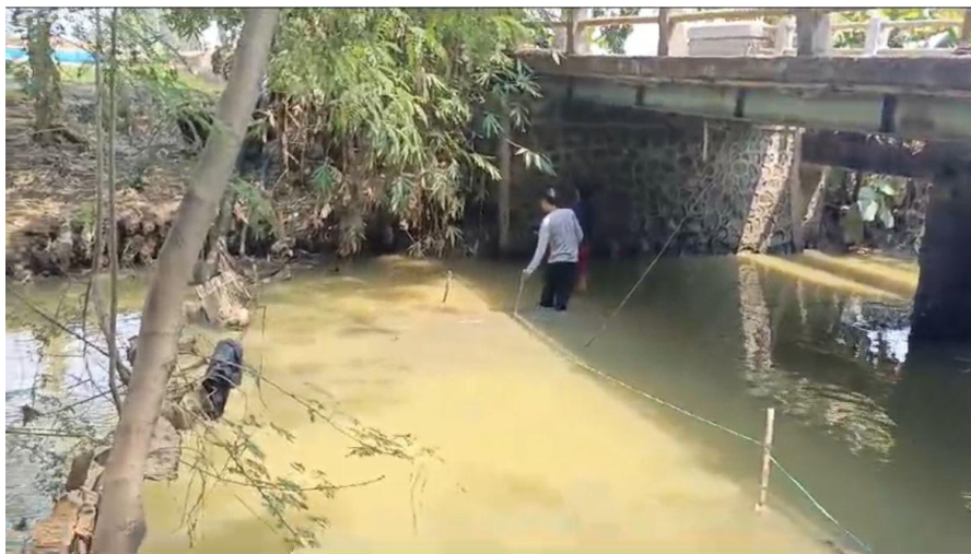
Gambar 10. Pengukuran kedalaman aliran sungai
