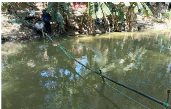
Gambar 7. Pengukuran waktu tempuh bola pingpong penampang 1 ke penampang 2
