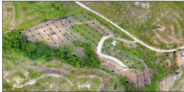
Gambar 2. Sistem perpipaan menggunakan EPANET 2.2 [7]
