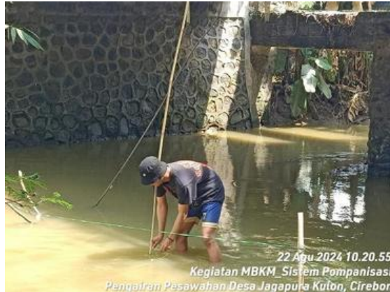
Gambar 108. Dokumentasi pengukuran kedalaman air sungai
