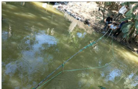
Gambar 8. Pengukuran lebar sungai
