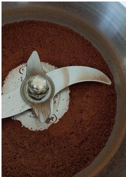
Gambar 19. Penggilingan Biji Kurma setelah dilakukan Proses Roasting
