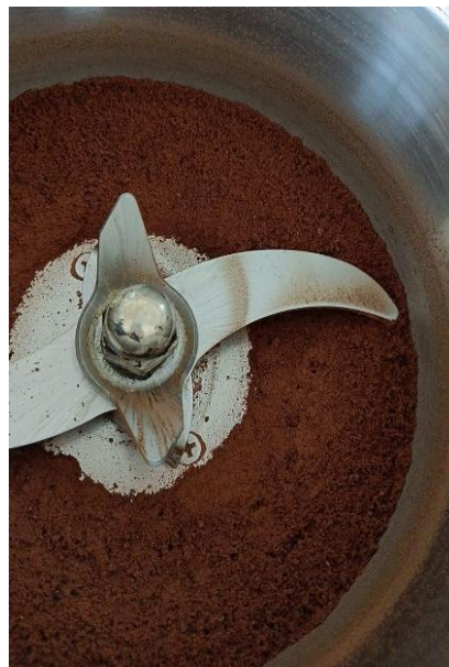
Gambar 10. Biji kurma yang di giling menggunakan mesin grinder (Dokumentasi, 2025)
