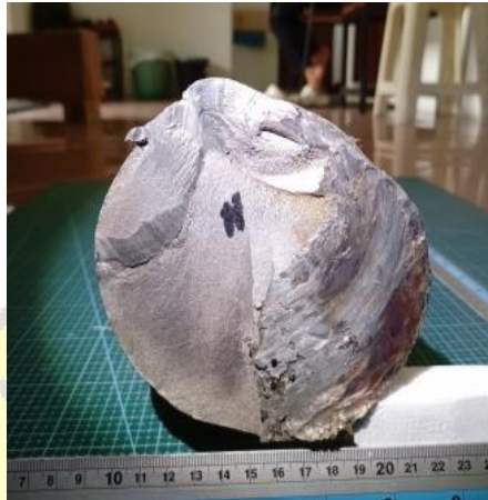
Gambar 10. Penampang Patahan Poros HWP
