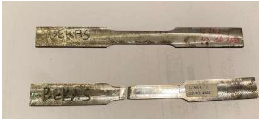
Gambar 3 Spesimen pegas daun bekas sebelum (atas) dan sesudah (bawah) uji tarik
