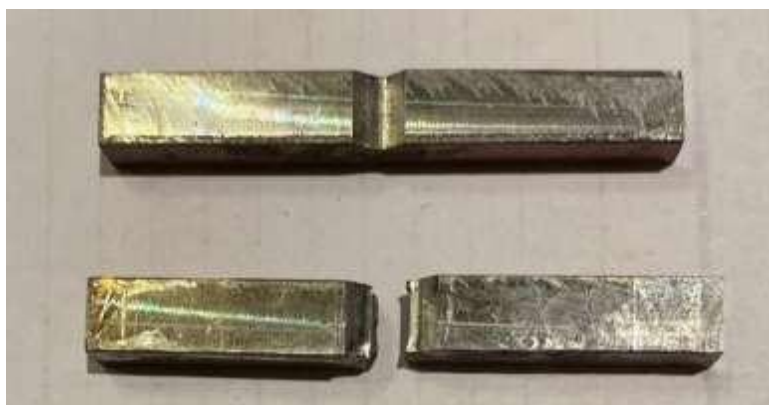
Gambar 6 Spesimen Impact Baru
