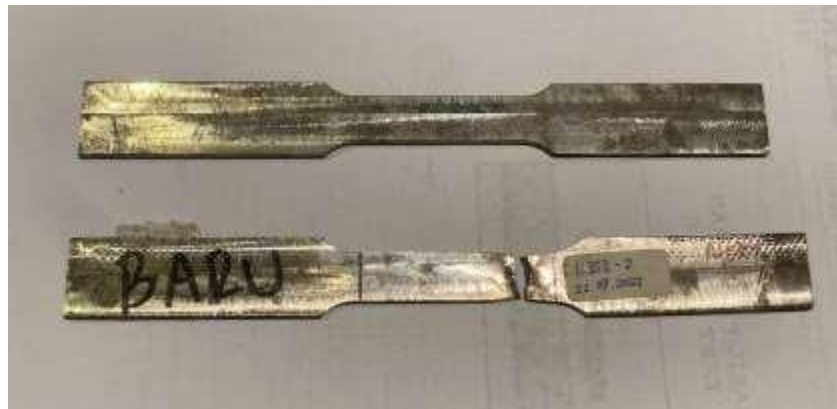
Gambar 4 Spesimen pegas daun baru sebelum (atas) dan sesudah (bawah) uji tarik
