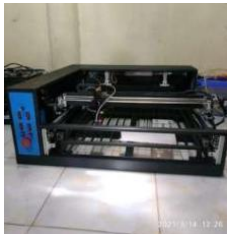
Gambar 2. Mesin laser CO 2 dengan controller mach3 [11]
