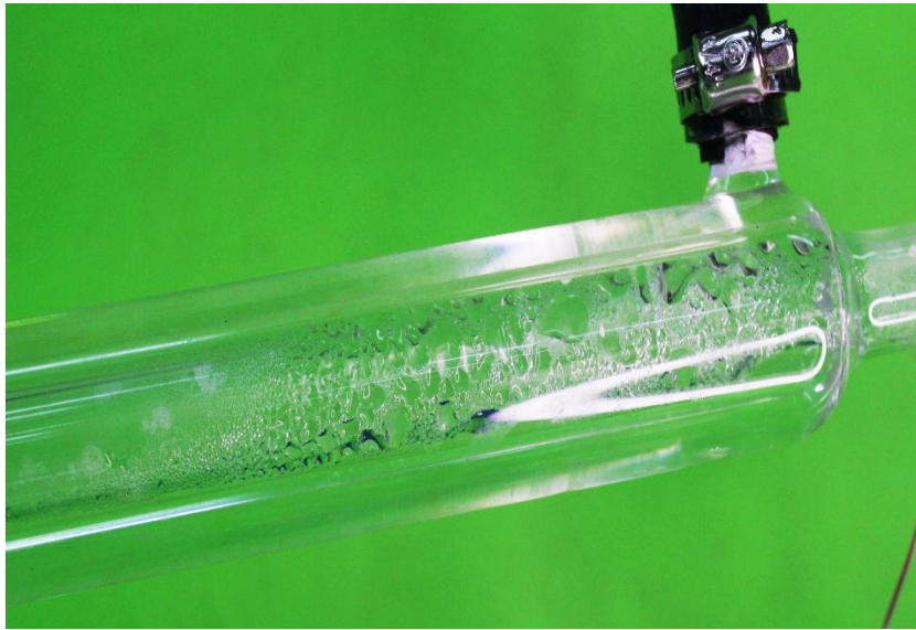
4.16 Film cair pada area kanan kondensor
