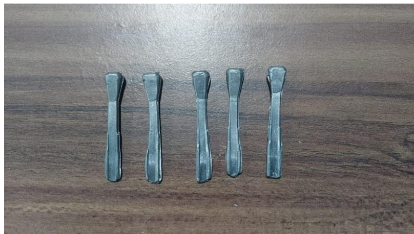
Gambar 56. Hasil penempaan proses pembentukan paku tapal kuda tahap 3.
