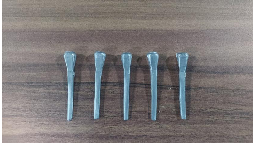
Gambar 57. Hasil penempaan pada proses pembentukan paku tapal kuda tahap 4.
