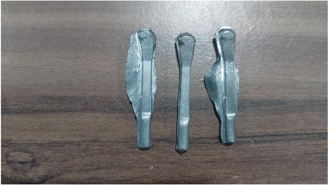
Gambar 42. hasil penempaan dengan kriteria nilai 0,75.
