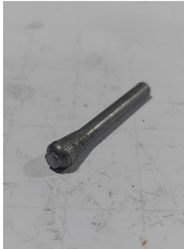
Gambar 37. Benda kerja tahap 2 pada proses pembentukan paku tapal kuda (hasil tahap upsetting ).
