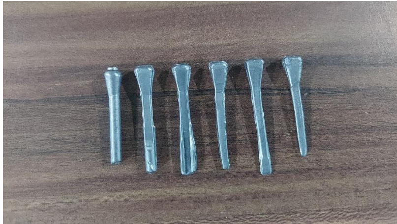
Gambar 55. Hasil penempaan dari tahap 1 hingga tahap 6.
