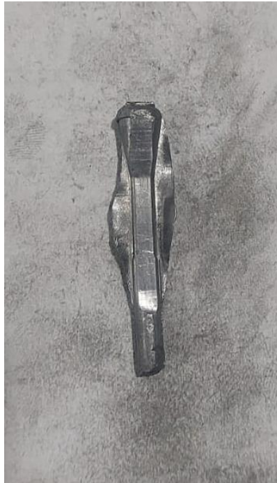
Gambar 40. Hasil penempaan tahap 2 pada proses pembentukan paku tapal kuda. (terdapat Flash )
