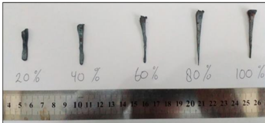
Gambar 1. Tahapan proses pembuatan paku tapal kuda lokal [1].
