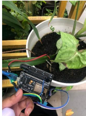
Gambar 2.4 Penempatan Alat Internet of Things (IoT) Sumber: Dokumentasi Pribadi, 2025
