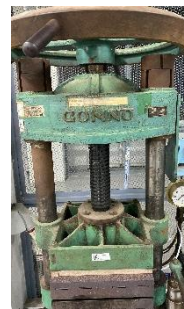
Hot press dengan suhu 135^{\circ}\text{C} dan tekanan 150 \text{ KgF/cm}^2
