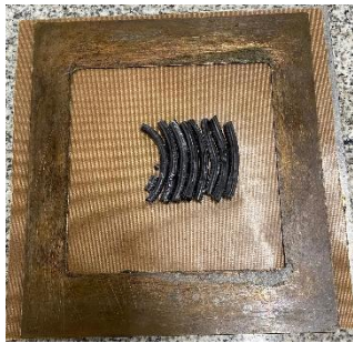
Press menggunakan teflon sheet dengan diberi spacer sesuai ketebalan yang diinginkan
