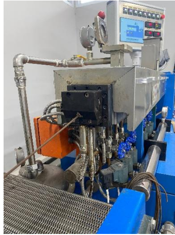
Ekstruksi menggunakan alat extruder
