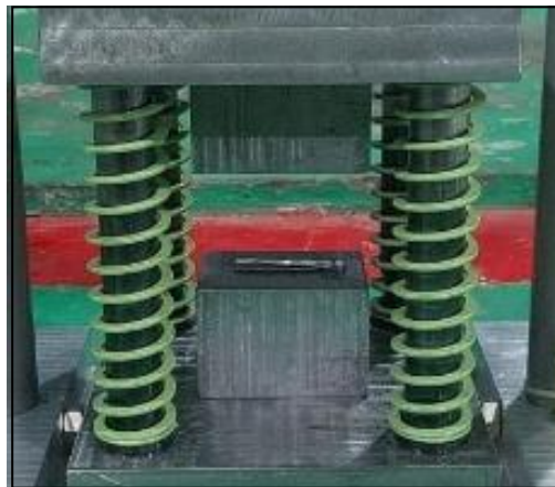
Gambar 36. Benda kerja sebelum penempaan
