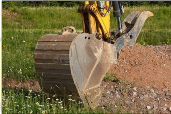
Gambar 1. Contoh rumah bucket eskavator yang mengalami keausan [2].
