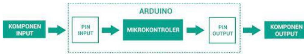
Gambar 4 Cara Kerja Arduino Uno
