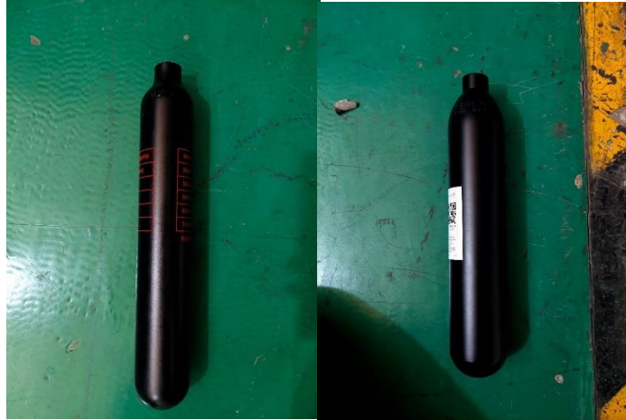
Gambar 13. Tabung senapan angin yang akan diuji
