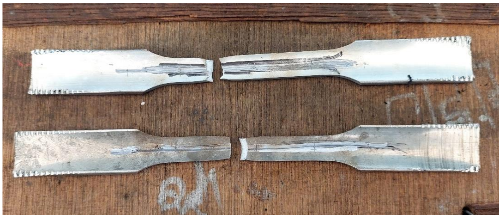
Gambar 26. Spesimen tabung senapan angin setelah dilakukan uji tarik
