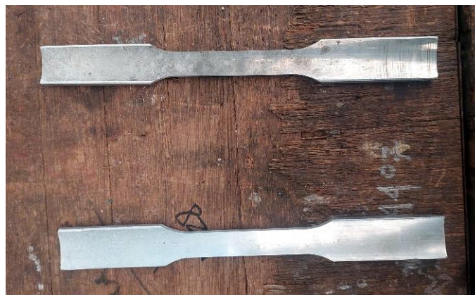
Gambar 19. Spesimen yang akan diuji tarik
