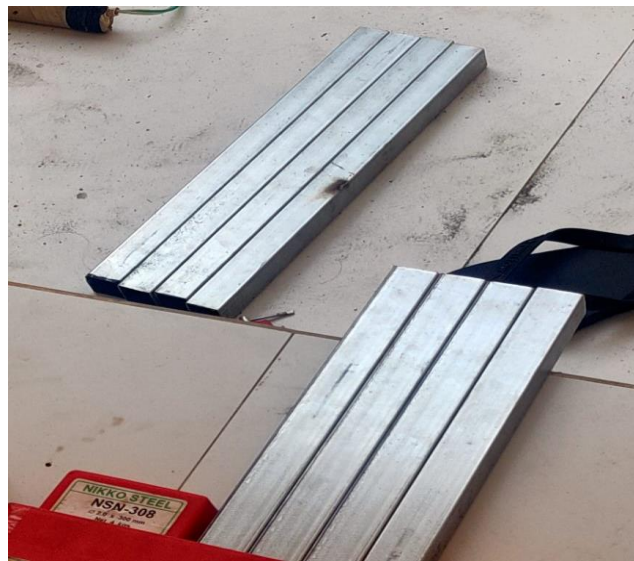
Gambar 31 Besi Holo Untuk Tinggi Dan Panjang
