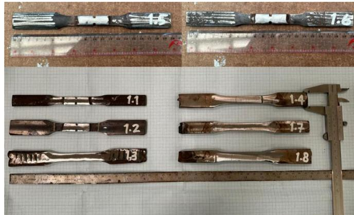
**Gambar 3. 26 Spesimen Uji Tarik**
