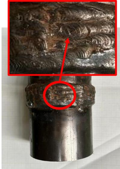
**Gambar 3. 29 Cacat Porositas**
