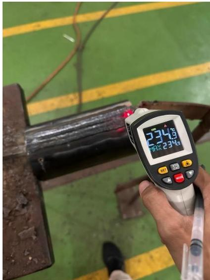
**Gambar 3. 20 Pendinginan Setelah Proses Pengelasan**
