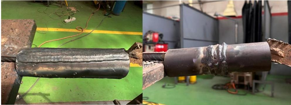
**Gambar 3. 19 Arah Pengelasan *Longitudinal* dan *Circumferential***
