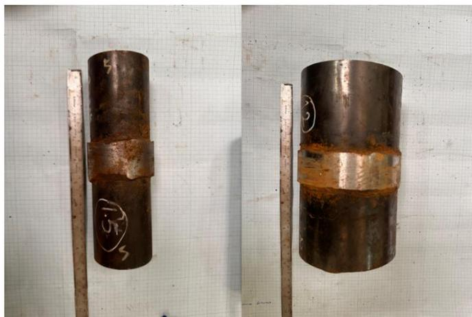
**Gambar 3. 22 Hasil Pembubutan Pipa Baja 2 inch (50 mm) dan 4 inch (100 mm)**
