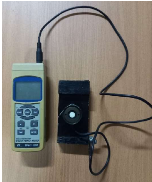
Gambar 14. Solar power meter
