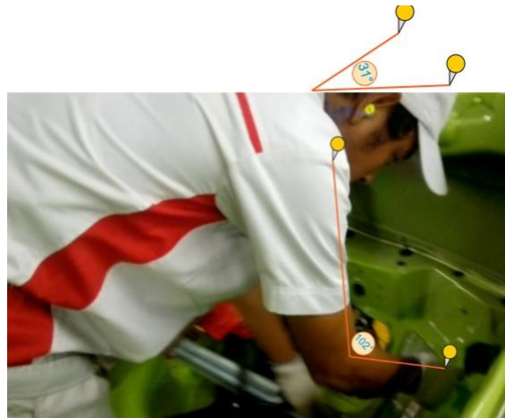
Gambar IV. 4 Postur Tubuh saat Melakukan Pengencangan Sekrup ( Tightening Bolt )
