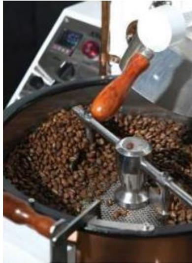
**Gambar 8. Proses Pendinginan Biji Kopi pada *Cooling Tray* [5]**
