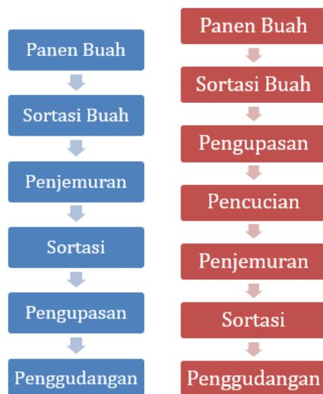
**Gambar 1. Tahapan Pengolahan Kopi Semi Basah (Kiri) dan Kering (Kanan) [1]**
