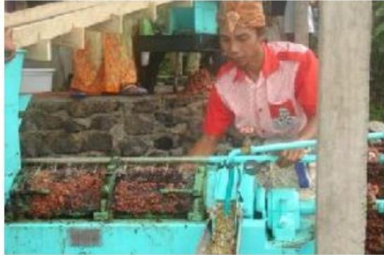
**Gambar 2. Proses Pengupasan Biji Kopi dengan Menggunakan Mesin *Pulper* [2]**
