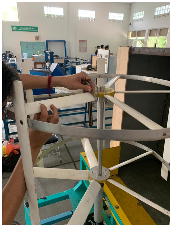
Gambar 32 Mengatur Sudut Pitch Sudu Horizontal Menggunakan Busur Derajat
