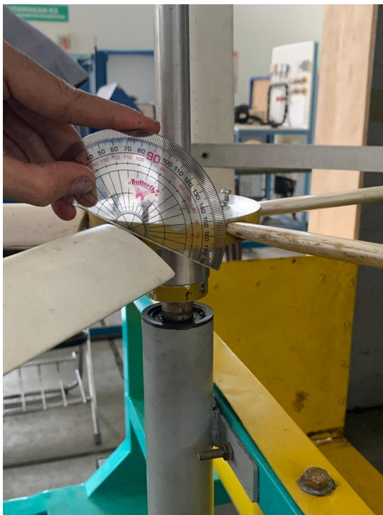
Gambar 32 Mengatur Sudut Pitch Sudu Horizontal Menggunakan Busur Derajat
