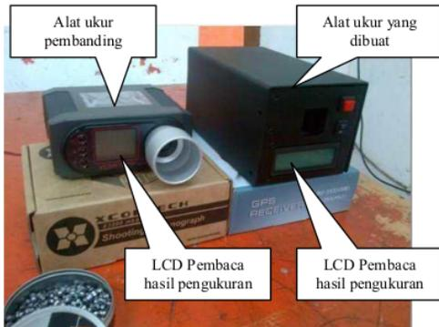
Gambar 7. Bentuk alat ukur yang dibuat dan perbandingnya
