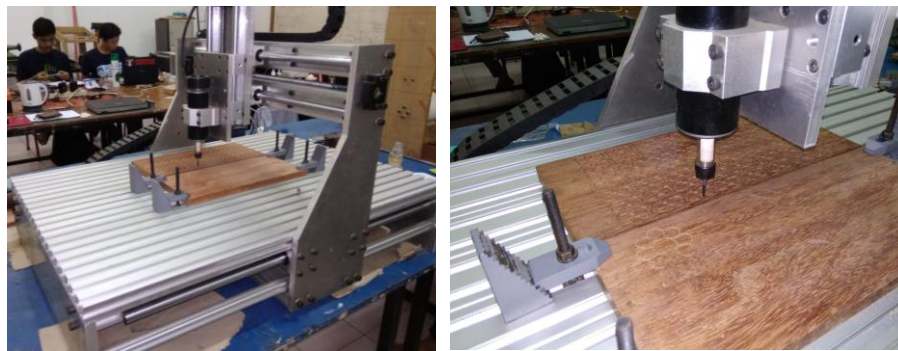
Gambar 1. Mesin router pembuat ukiran kayu [2]
