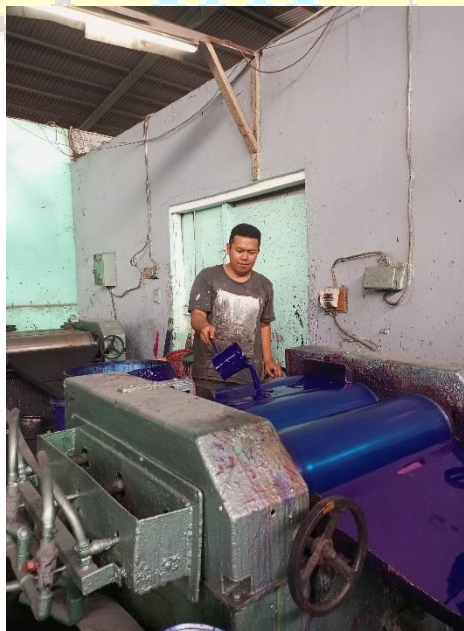
Gambar V. 1 Operator Produksi Cat Solven Base pada mesin Triple Rollermil
