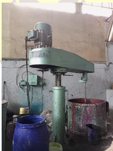
Gambar V. 3 Mesin Mixer Dalam Pembuatan Cat Water Base
