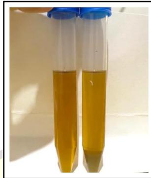
Gambar 12. Hasil Trial Pemurnian Minyak Menggunakan Adsorben Bentonit
