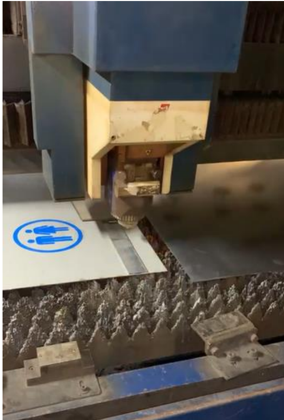
Proses Pembuatan Spesimen Uji Tarik Dengan Laser Cutting
