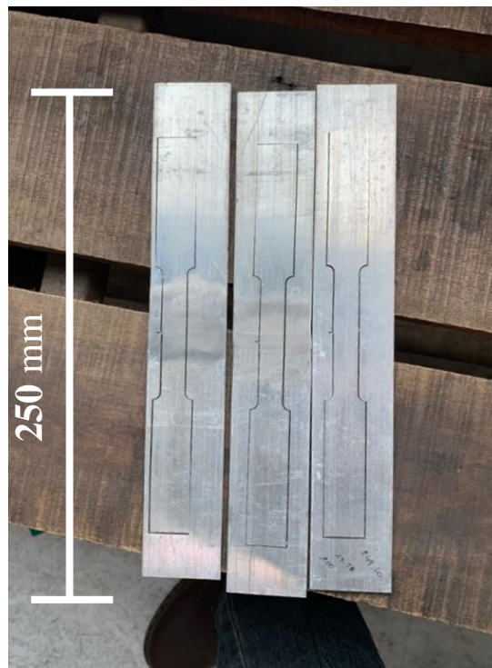
Gambar 23. Hasil Laser Cutting Spesimen Uji Tarik
