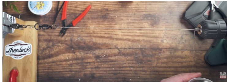
Gambar 3. Proses penggulangan kawat secara manual
