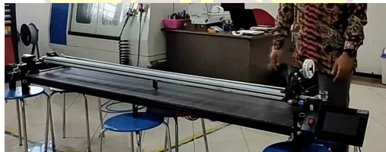
Gambar 4. Mesin penggulung kawat komponen atomizer otomatis
