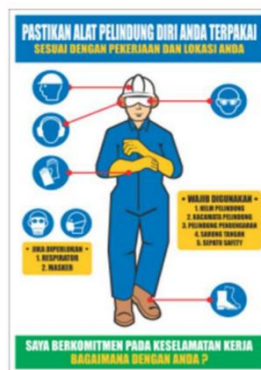
Gambar 8. APD yang digunakan dalam keadaan tertentu [8]
