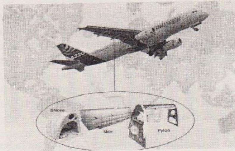
Gambar 1.3 Ilustrasi Struktur Bentuk Komponen D'Nose, Skin,Pylon Pesawat Airbus A320/A321 yang dibuat di PT.Dirgantara Indonesia
