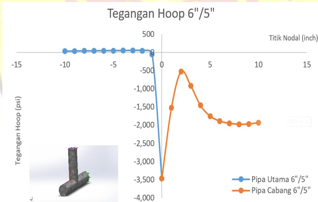
Gambar 4. 7 Tegangan hoop pipa 6"/5" (sisi kanan)
