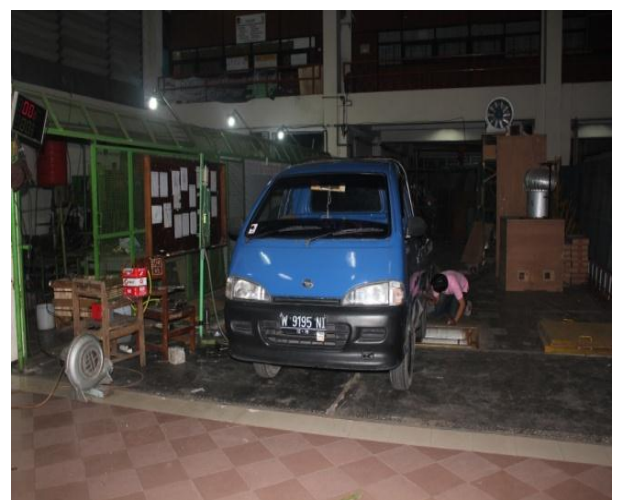
Gambar 4. Pengujian konsumsi BBM dan daya pada Daihatsu Zebra 1300cc sebelum dan sesudah menggunakan generator gas HHO.
