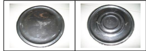
Gambar 11. Hasil proses pembentukan rubber forming pada produk sarangan dandang vahan stainless steel
