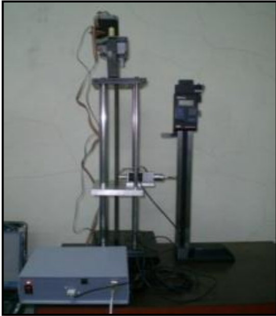
Gambar 9. Set-up pengukuran ketegaklurusan dengan Digimetic Height Gage
