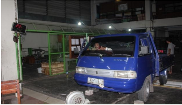
Gambar 5. Pengujian konsumsi BBM dan daya pada Suzuki Carry 1500 cc sebelum dan sesudah menggunakan generator gas HHO.
